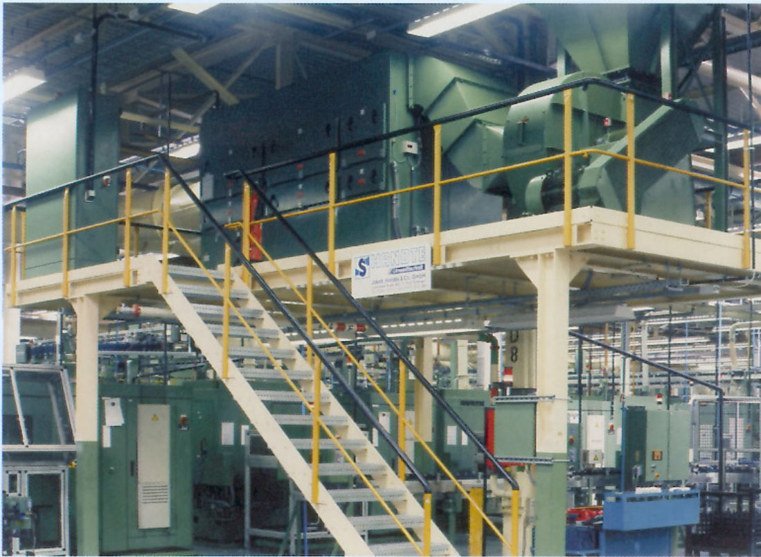
Öl- und Emulsionsnebel- Abscheider Typ OE-D auf Bühne angeordnet
